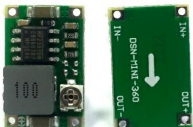
Использование dc-dc позволяет использовать практически произвольный не стабилизированный источник напряжения. Например, я использую, 12ти-вольтовый блок питания от старого радиотелефона. Потребляемый ток при использовании 12-вольтового источника не превышает 200mA. Регулировкой напряжения достигается комфортная яркость свечения индикаторов.
